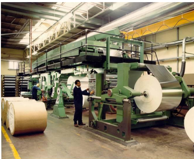
Figuur 5: gewalst aluminium komt op een rol terecht.
